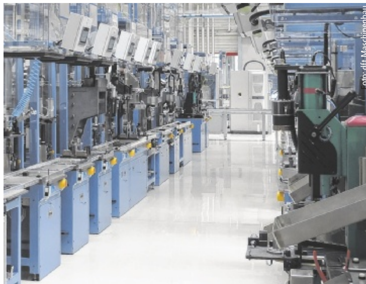
Eine innovative LEAN-Anlage zur Fertigung von Verteilergetrieben
